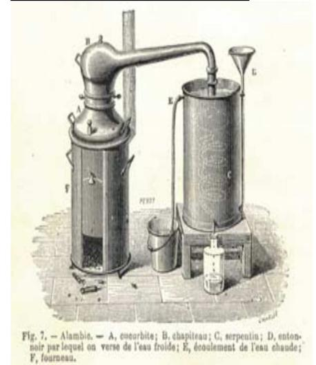
Fig. 7. — Alambic. — A, cucurbita; B, chapiteau; C, serpentis; D, entonnoir par lequel on verse de l'eau froide; E, écoulement de l'eau chaude; F, fourneau.
